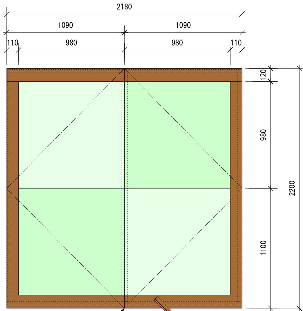
跳ね上げ構造のため、3mm隙間ができます。
